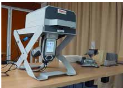
Abb. 3: Bindemittelanalytik mit der Röntgenfluoreszenzspektroskopie
