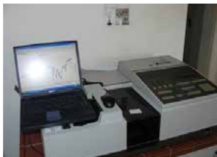
Abb. 4: Bindemittelanalytik mit der Infrarotlicht-Spektroskopie
