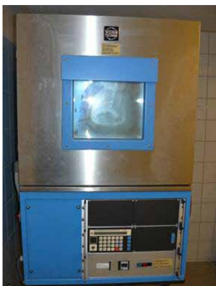
Abb. 7: Klimaschrank zur Prüfung bauphysikalischer Parameter von Mörtel und Farbe
