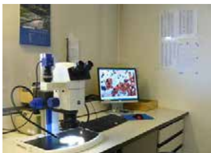
Abb. 6: Aufflichtmikroskopie zur Beurteilung des Wandaufbaus und der Schichtanzahl
